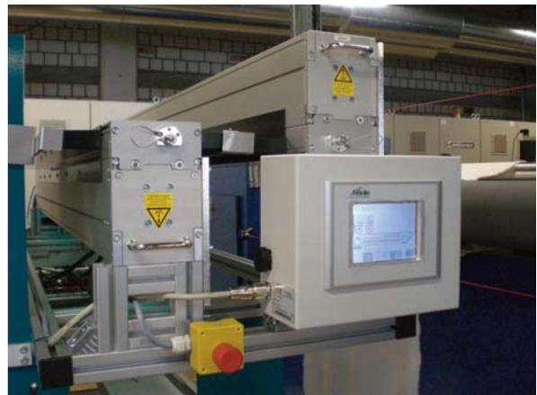
pureUV-Strahler auf einer Anlage der ITV Denkendorf
