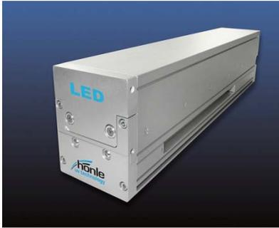
Dieses wassergekühlte UV-LED-Array wurde speziell für bahnförmige Anwendungen wie den Flexodruck entwickelt, wo es beim Pinning und zur Endtrocknung eingesetzt wird. Die LED Powerline Flexo erreicht Intensitäten bis zu 16.000 mW/cm<sup>2</sup>. Durch ihr modulares Design kann die Länge optimal an die jeweilige Anwendung angepasst werden.
